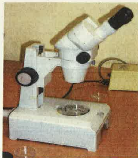
Fotografía 3.3. Microscopio utilizado para inventario micropaleontológico.
